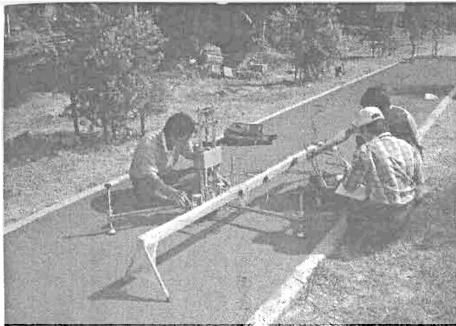
การทดสอบเพื่อหาค่ากรวยตัวในแนวตั้ง
