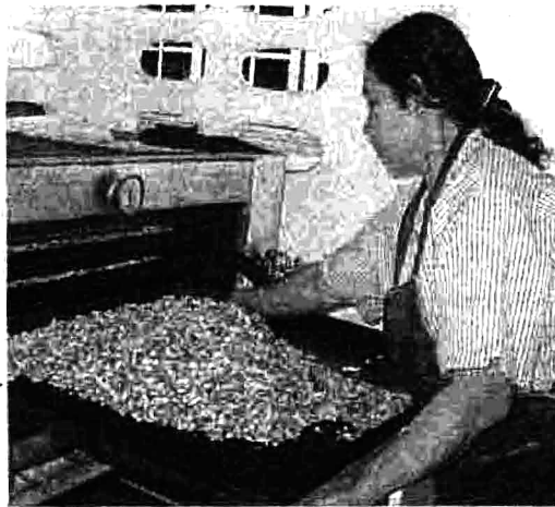
หลังจากเผาและคัดแล้วก็นำเข้าอบอีก 2 ชั่วโมง
